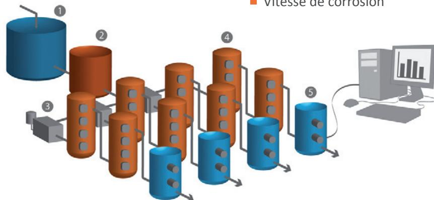
① Nutriments    ② Chemostat (réservoir de microorganismes sauvages actifs)
